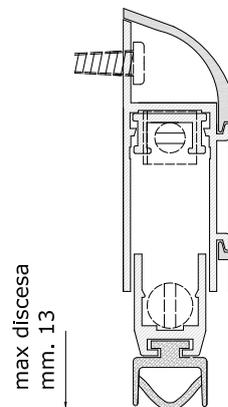
**Funzione:** chiusura automatica della fessura tra porta e pavimento per eliminare spifferi d'aria, infiltrazioni di polvere, insetti, fumo e per ridurre il passaggio di rumore
